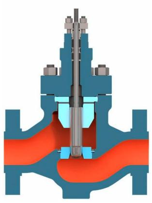
流体通道呈 S 型,压降损失小,流量大,可调范围广。 阀芯部分导向面积大,抗振性能强。调节阀泄漏量符 合 ANSI B16.104 标准。调节阀配用气动薄膜或气缸 执行机构或电动执行机构,其结构紧凑,输出力大。 调节阀广泛应用于高温及高压场合。 产品符合 GB/T4213-2008 标准
