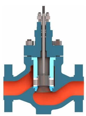
◆在高压笼式调节阀的基础上进行改进,套筒上设有单级或多级低噪音孔,完全控制流经阀内件的流体流速,可大幅降低高压差气体或蒸汽所产生的噪音,也可有效降低液体产生气蚀现象。阀体结构紧凑,流体通道呈S型,使其压降损失小,流量大,可调范围广,流量特性精度高,符合 IEC534-2-1976 标准。 调节阀泄漏量符合 ANSI B16.104 标准。调节阀配用多弹簧薄膜或气缸执行机构或电动执行机构,其结构紧凑,输出力大。
